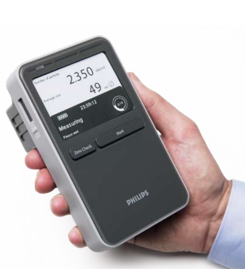
Met de NanoTracer kan een werknemer de concentratie nanodeeltjes vaststellen
